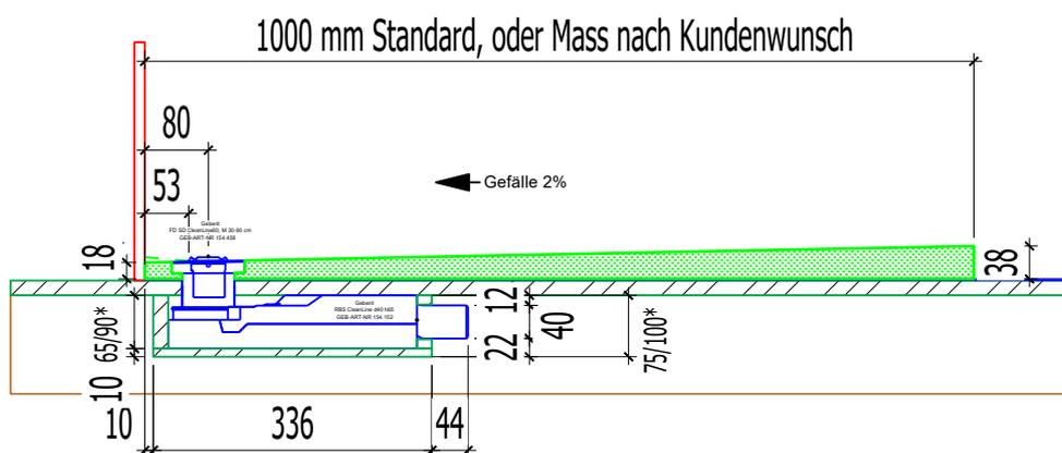
\*Bodenablauf Typ 90 mit Ablaufleistung 0.8 l/s, Siphonierhöhe 50mm gem. Norm SN 5900
